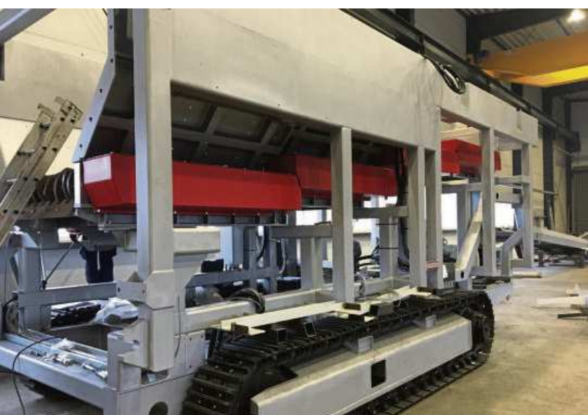
Im Portfolio der Firma Hermann sind nicht nur Schleusen, sondern auch andere Großgeräte wie dieser mobile Steinbrecher. Die Spezialanfertigung (30 Meter lang, 5 Meter hoch) geht mit einem Gesamtgewicht von 70 Tonnen demnächst nach Russland.
